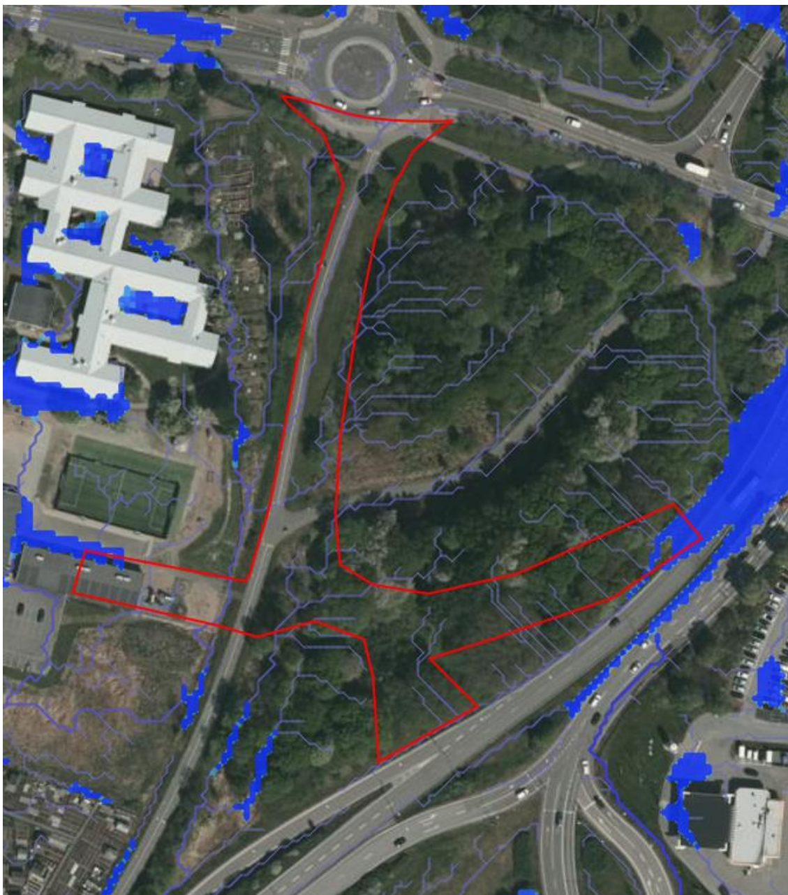
Figur 5 Lågpunkter och rinnvägar inom järnbrottsprästväg och Antenngatan (rött) med befintliga rinnvägar och lågpunkter (Scalgo Live, 190919).
