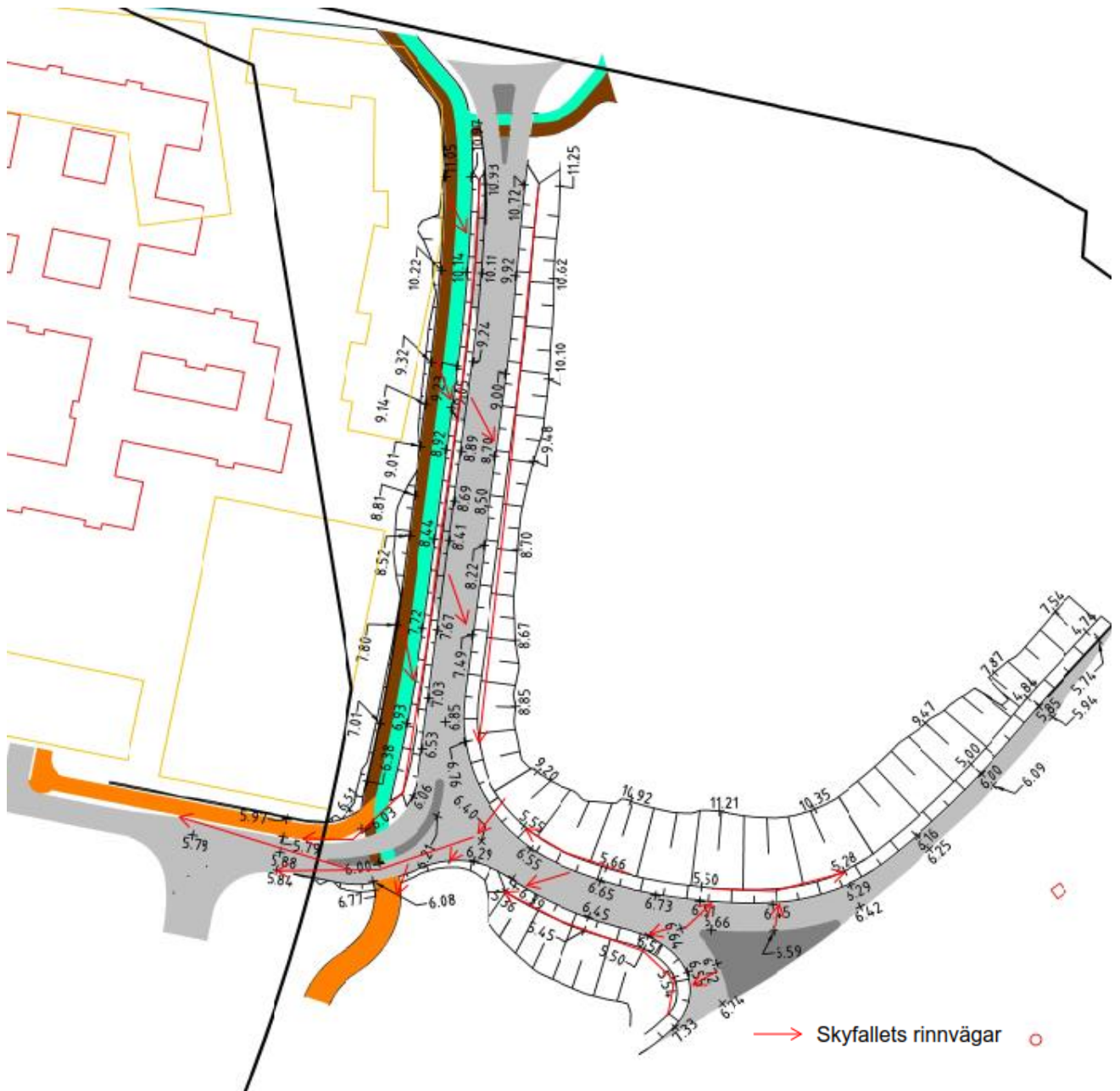
Figur 3. Principiell skiss av skyfallens rinnvägar.
