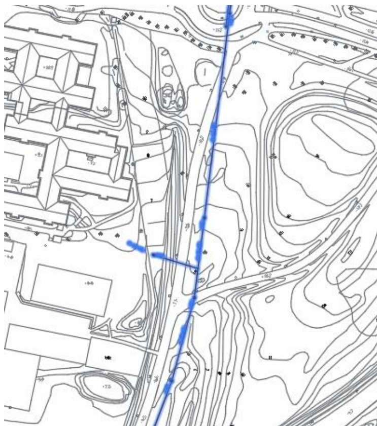
Figur 4 Kretslopp och vattens befintliga spillvattenledning.
